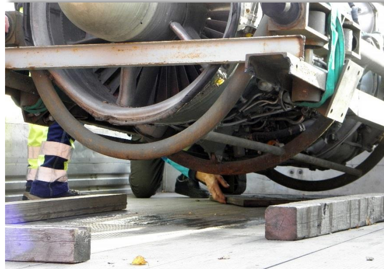
Fastsättning av motorn på lastbilsflaket.
